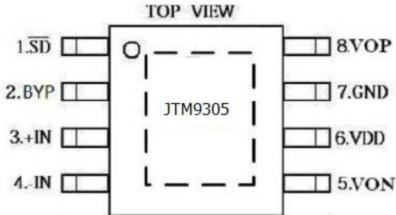
图为 JTM9305 ESOP.8 封装的管脚分布图。
