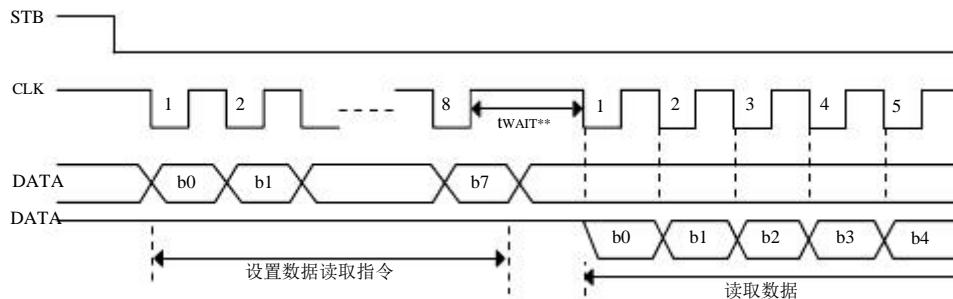
因为 DATA 管脚为 N 管开漏输出，所以该脚要连接一个外部上拉电阻（ $1\text{K}\Omega \sim 10\text{K}\Omega$ ）。
