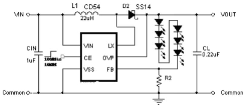
注:电路中  $R2=VFB/I_{LED}$ ,  $VFB$  为 FB 端输出电压,  $I_{LED}=20mA$
