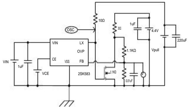
注：所有测试电路中  $R_{LED} = V_{FB} / I_{LED}$ ,  $V_{FB}$  为 FB 端输出电压,  $I_{LED} = 20\text{mA}$ ; 如  $V_{FB} = 0.25\text{V}$ , 则  $R_{LED} = 12.5\Omega$
