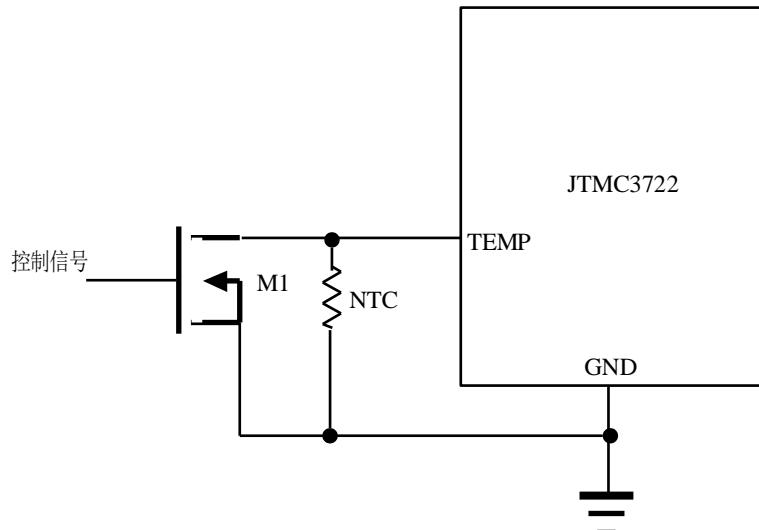
当控制信号为高电平时，M1导通，TEMP管脚为低电平，禁止充电；
