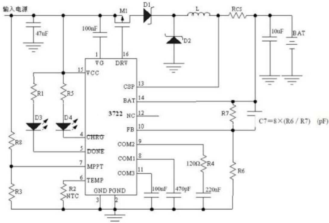
①输入电源 VCC 的选择：一般情况下，比串联的充电电池饱满电压高 2V，但是最高不能超过 28V。
