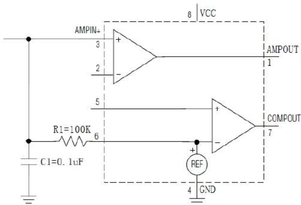
图5 RC滤波电路消除REF管脚的干扰
