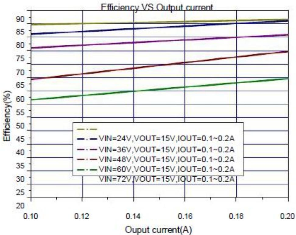
图 9. JTMX7005A 系统效率曲线
