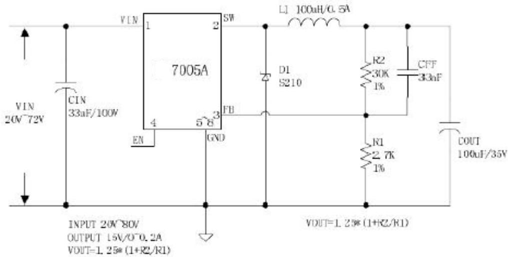
图 8. JTMX7005A 系统参数测量电路 (VIN=20V~80V, VOUT=15V/0.2A)
