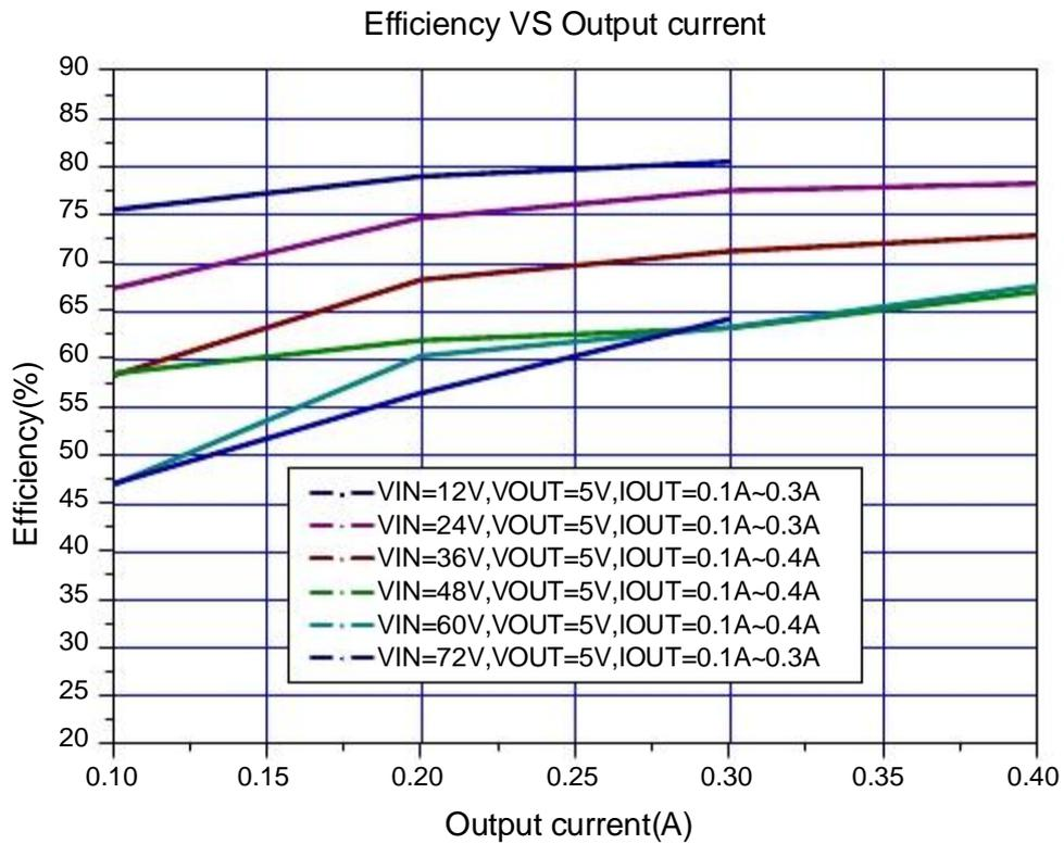
图 11. JTMX7005A 系统效率曲线
