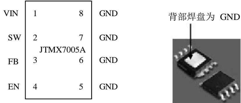
图 2. JTMX7005A 引脚配置
