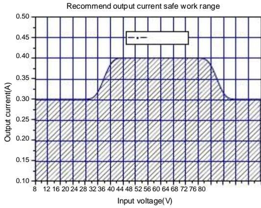
图 5.最大输出电流(VOUT=5V)
