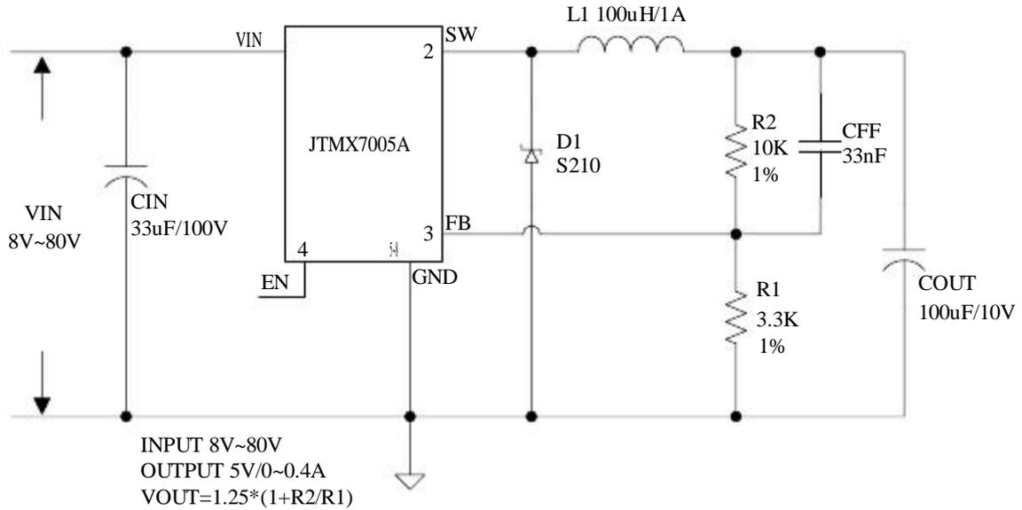
图 10. JTMX7005A 系统参数测量电路(VIN=8V~80V, VOUT=5V/0.4A)
