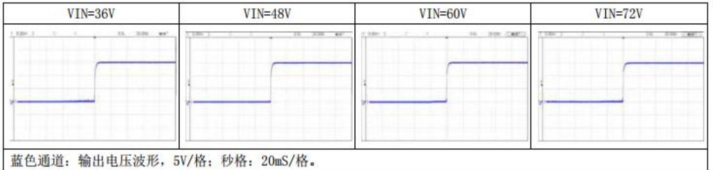
EN 控制使能输出电压波形:
