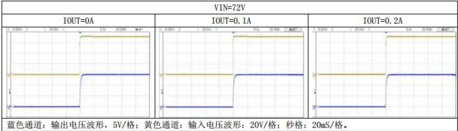
短路撤销后输出电压波形:
