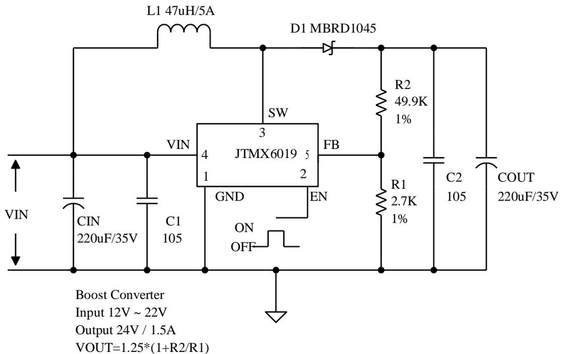
图 4. JTMX6019 系统参数测量电路
