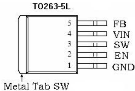
图 2. JTMX6019 引脚配置
