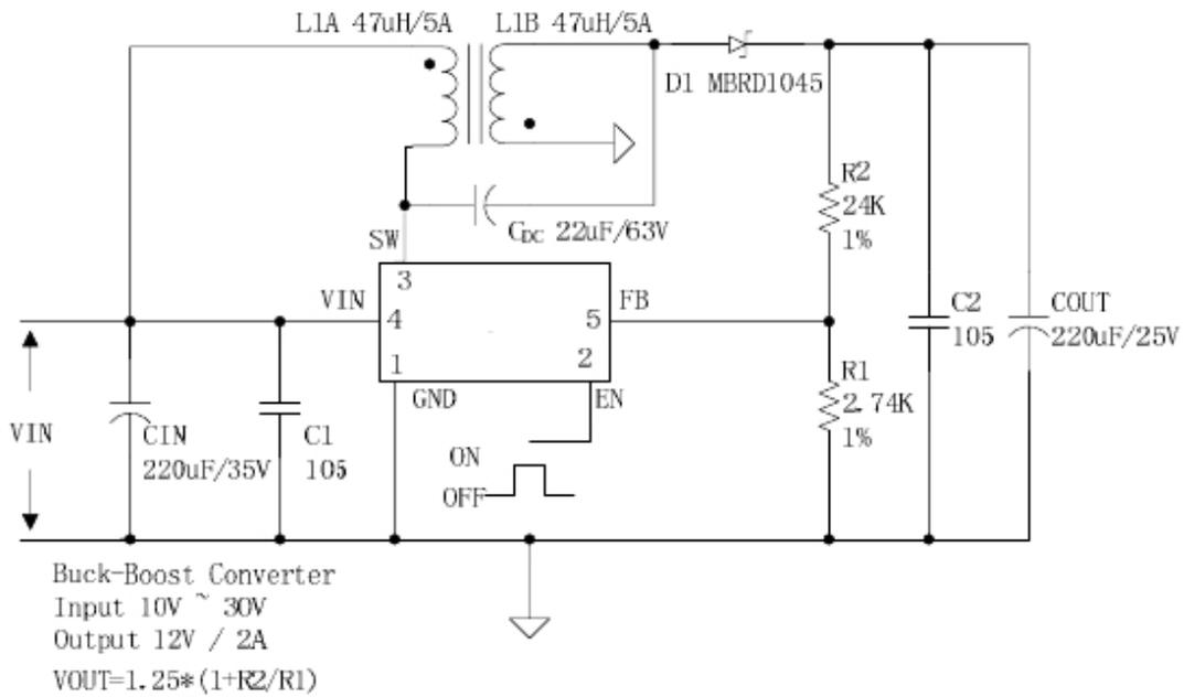
图 17. JTMX6019 系统参数测量电路
