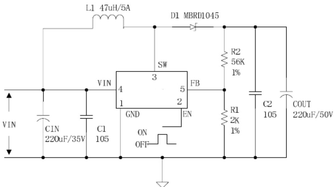
图 13. JTMX6019 系统参数测量电路 (VIN=10~32V,VOUT=36V)
