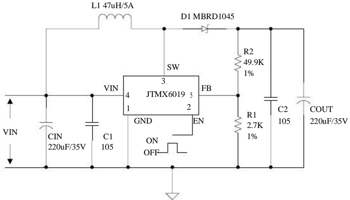
图 9.JTMX6019 系统参数测量电路 (VIN=12V,VOUT=24V)
