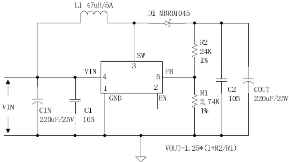
图 11. JTMX6019 系统参数测量电路 (VIN=5V,VOUT=12V)
