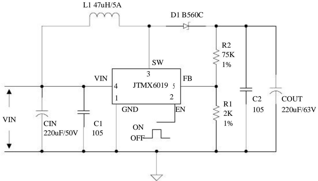
图 15. JTMX6019 系统参数测量电路 (VIN=20~40V,VOOUT=48V)
