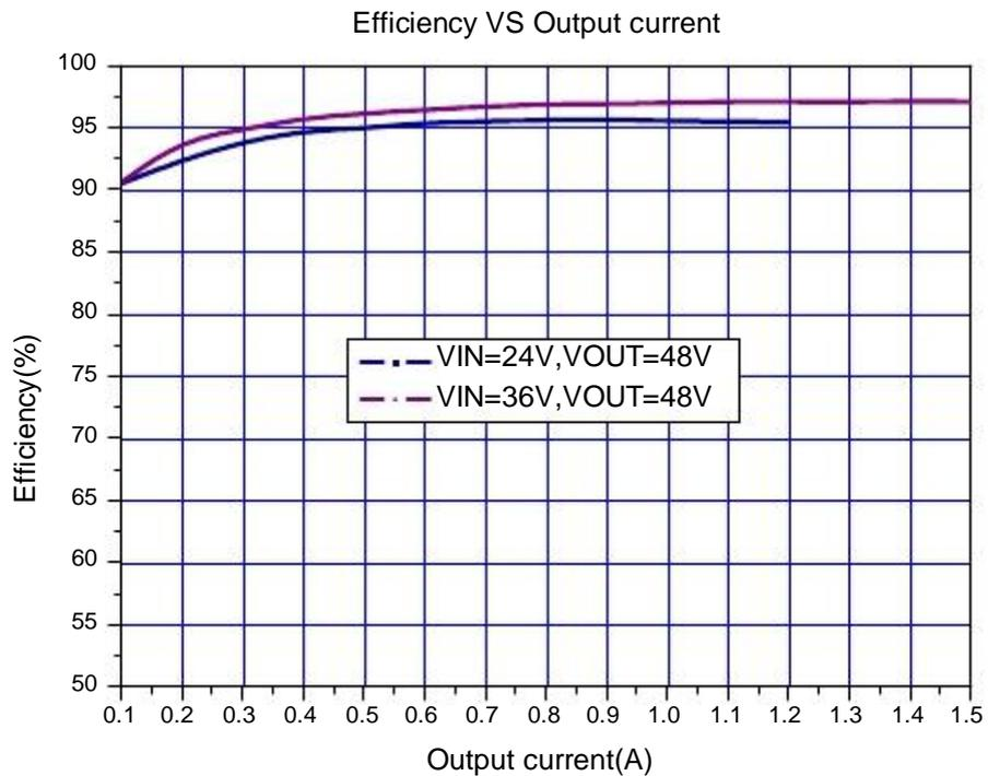
图15. JTMX6019系统效率曲线
