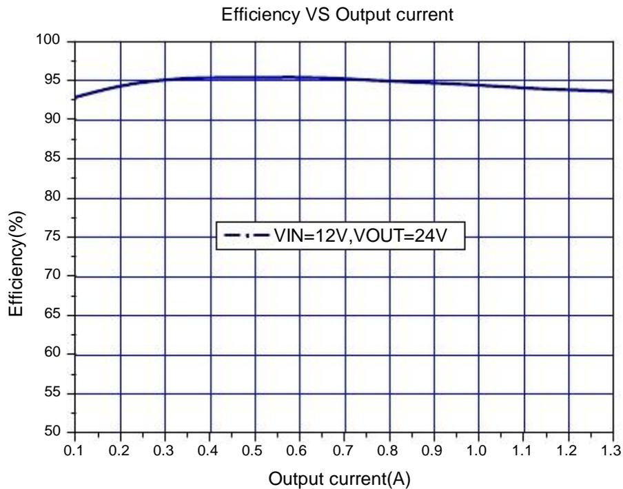
图10. JTMX6019系统效率曲线
