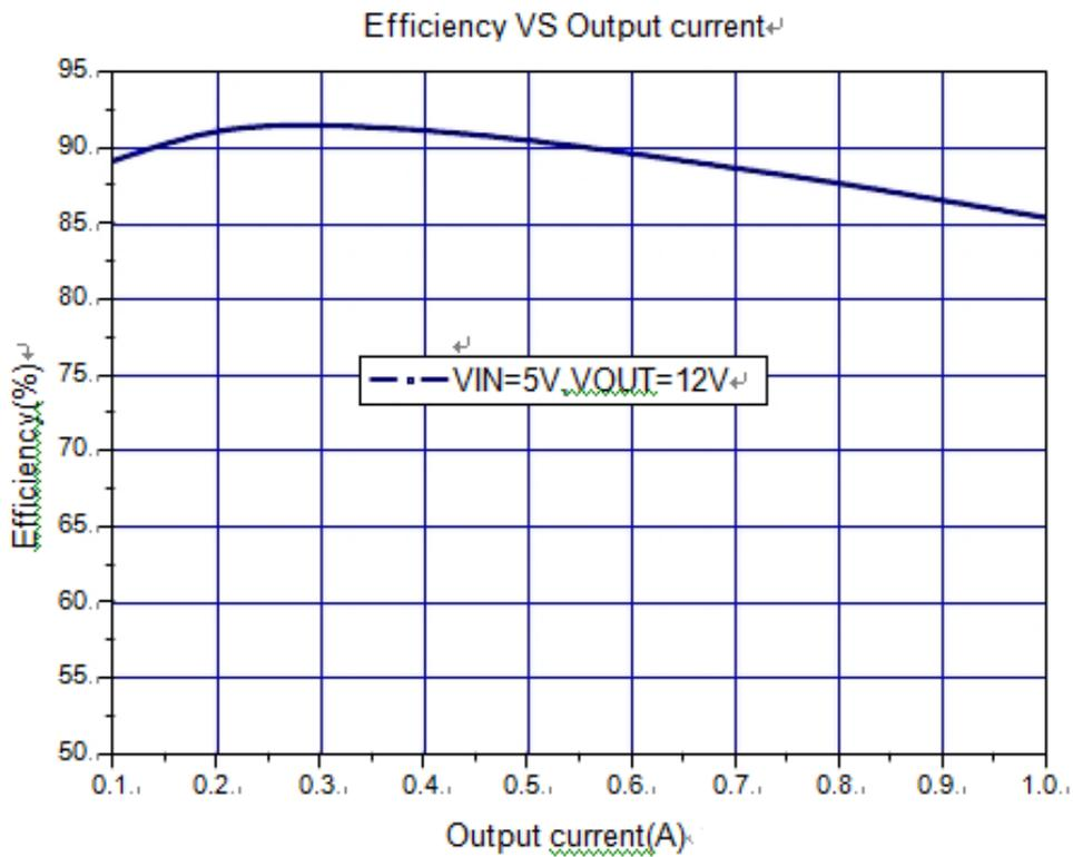
图12. JTMX6019系统效率曲线
