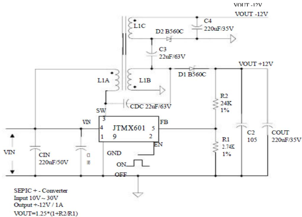
图 18. JTMX6019 系统参数测量电路
