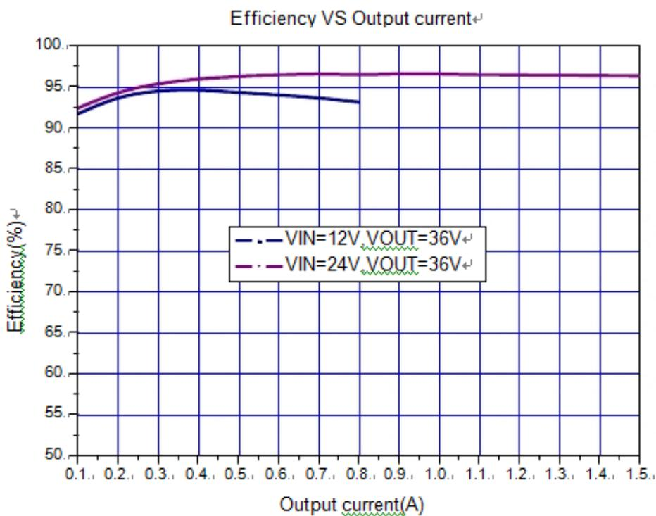
图14. JTMX6019系统效率曲线
