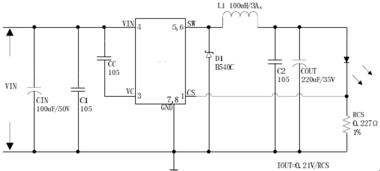
图 16. JTMX3786 系统参数测量电路 (VIN=8V~40V, IOU=925mA)
