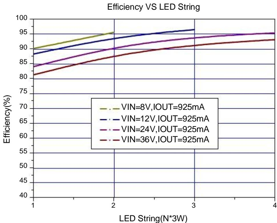
图17. JTMX3786系统效率曲线
