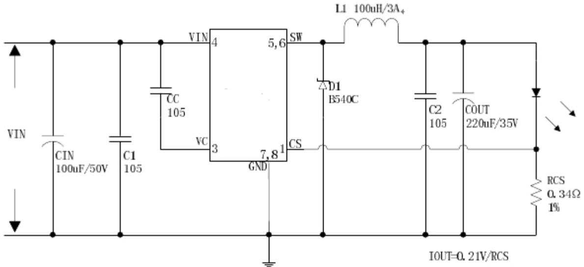
图 14. JTMX3786 系统参数测量电路 (VIN=8V~40V, IOU=615mA)
