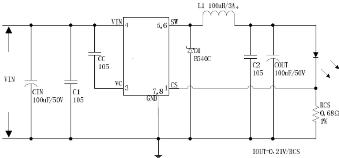
图 12.JTMX3786 系统参数测量电路 (VIN=8V~40V,IOU=308mA)
