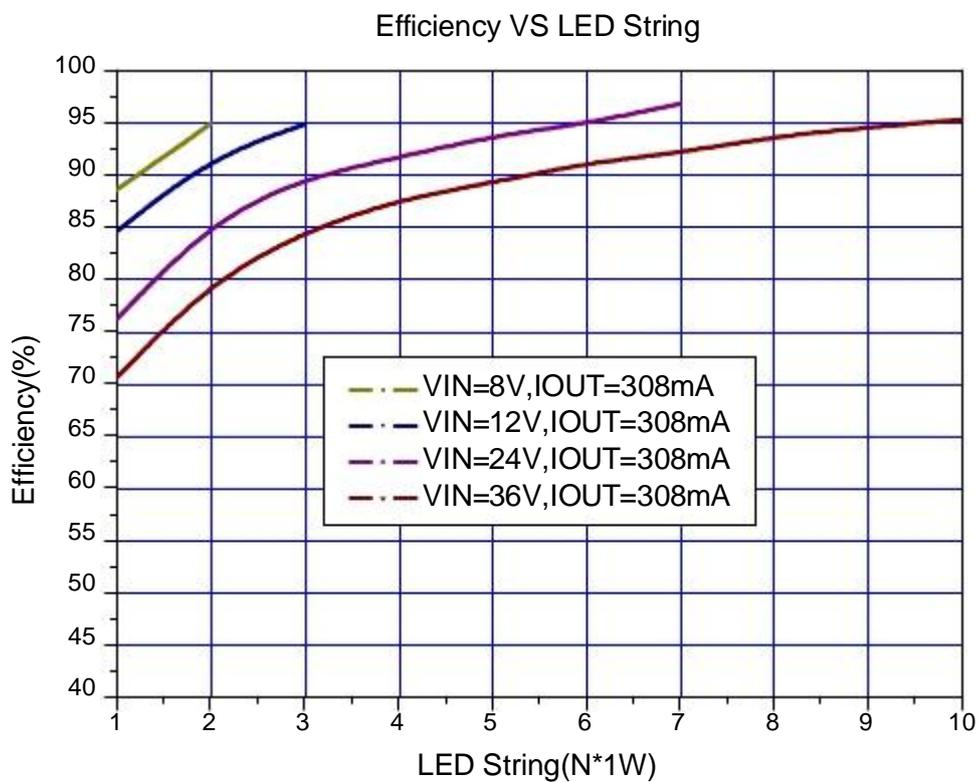
图13. JTMX3786系统效率曲线
