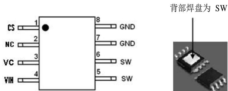
图 2. JTMX3786 引脚配置
