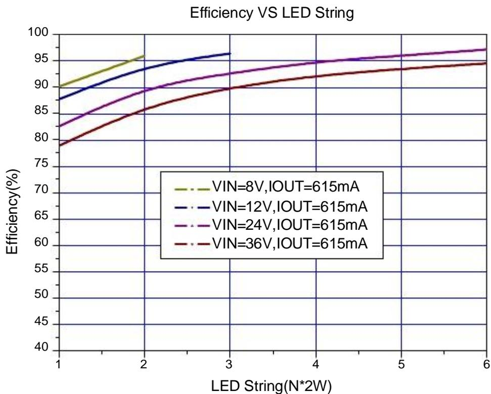
图15. JTMX3786系统效率曲线
