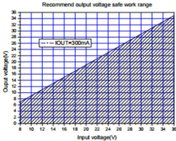
图 5.最大输出电压(IOUT=300mA)
