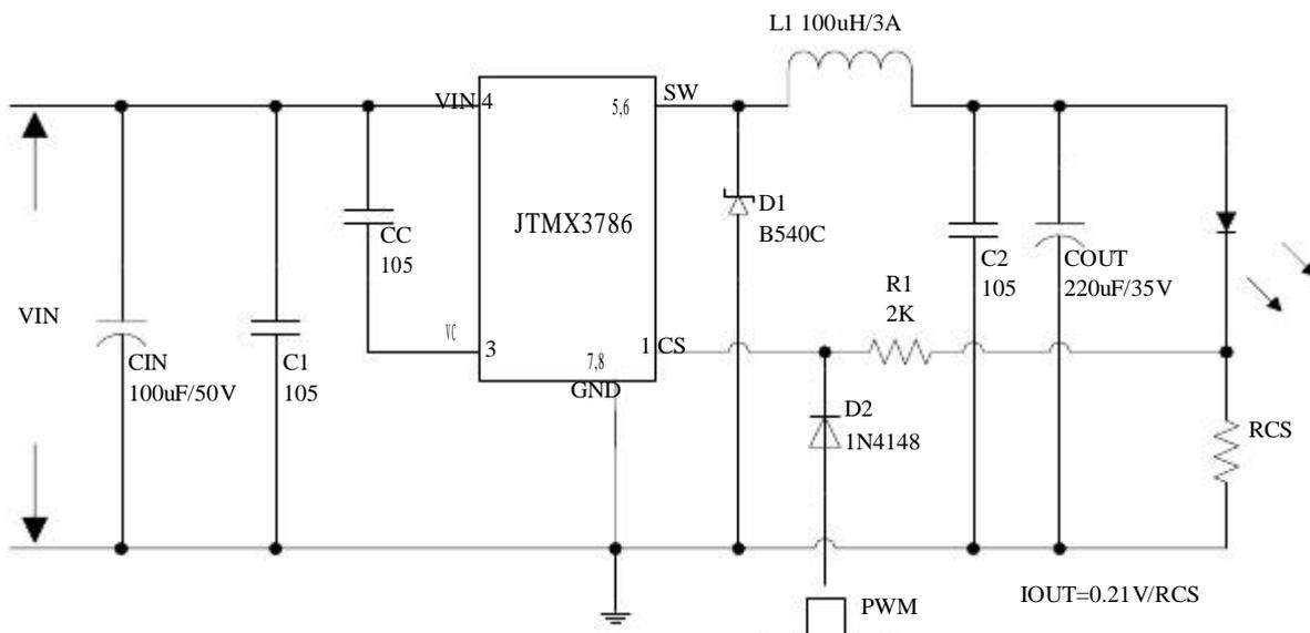
图 18. JTMX3786 系统参数测量电路（PWM DIMMING）
