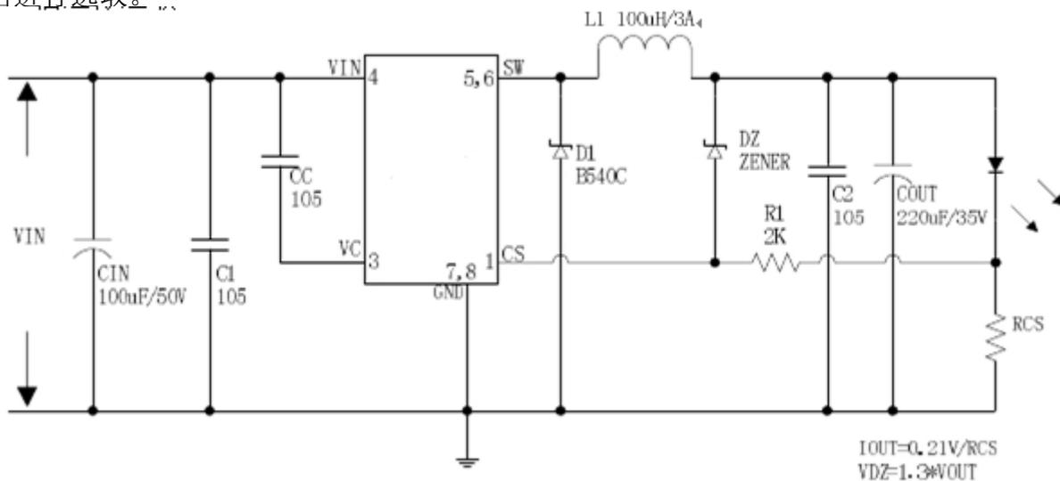
图 18. JTMX3786 系统参数测量电路（LED OVP）
