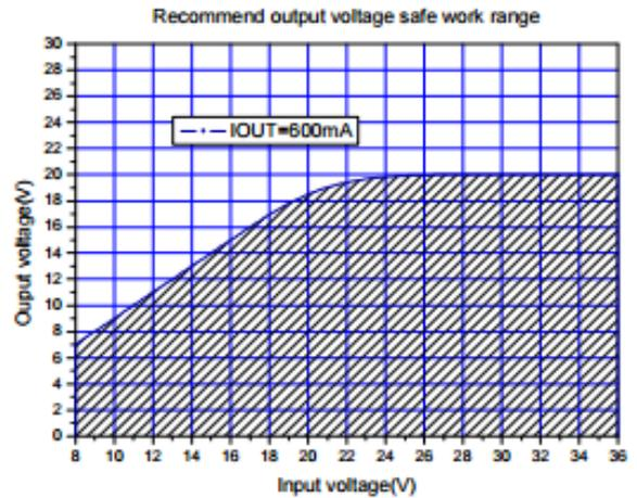
图 6.最大输出电压(IOUT=600mA)
